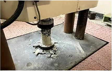
図 15 万能試験機による破壊試験
