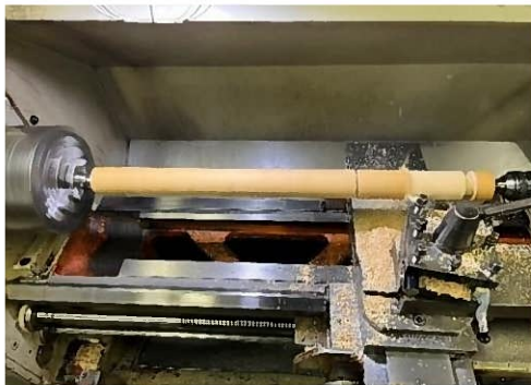
旋盤作業状況（グリップ部分）
