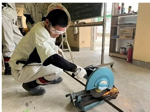
鋼材切断状況 1
