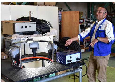
◀水流発生技術を応用して、酸欠や有毒ガスが発生しがちなマンホール内の換気装置も開発しているエビスマリン。開発の苦労や大学・下水道局との協働についてお聞きます。
